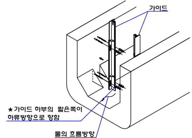
5. 천공구멍에 앵커볼트 삽입 및 가이드 설치 후 와셔, 스프링와셔, 너트로 단단하게 고정 (\*중요: 양쪽 가이드의 수평 및 평행확인)
